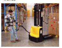
Cuando el apilador esté bajada, suelte el freno para mover la unidad manualmente.
