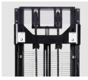
Diseño de doble cadena Comparado con el diseño de cadena simple, tiene mayor resistencia, es más seguro y más estable.
