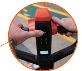
La función de conducción con el timón en posición vertical facilita el trabajo en áreas confinadas como ascensores o camiones sin comprometer la seguridad
